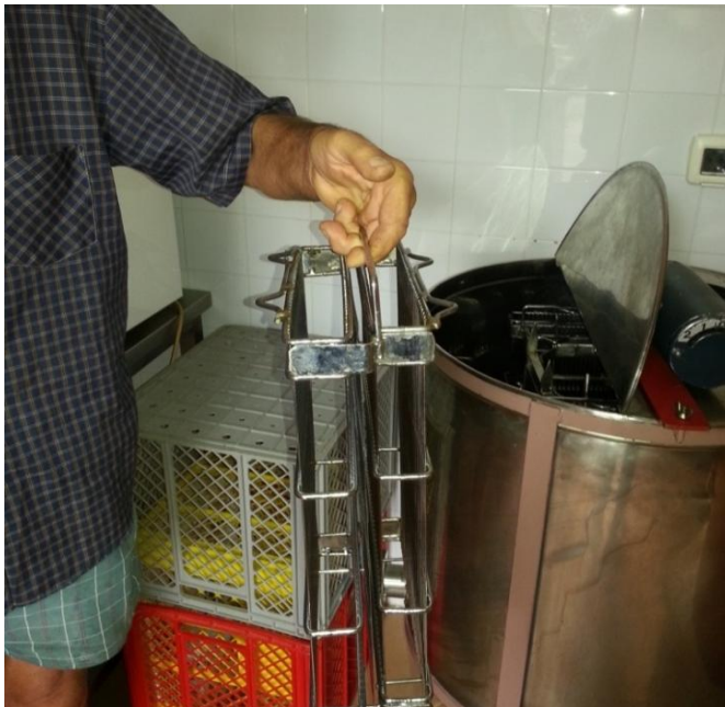
Der Imker Ruzic Jovakin demonstriert uns die Doppelwabentaschen in seinem Schleuderraum. Zwischen den beiden verbundenen Wabentaschen befindet sich eine Edelstahlplatte, die das Ausschleudern zweier Waben übereinander zulässt.
